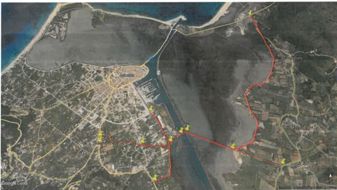
Εικ. 4. Προτεινόμενη Λύση: Οδευση στην ανατολική ακτή, ή, εν μέρει, σε επίχυμα εντός της λιμνοθάλασσας του Αβλέμονα, παραπλεύρως της ακτής. Πλωτή ανοιγόμενη γέφυρα στα σημεία Z1-Z2 (ή υποθαλάσσια ζεύξη, υπό προϋποθέσεις) που διέρχεται από τα σημεία Z1-Z2 ή εγγύς αυτών. Τελικό τμήμα Z2-Z3 χαμηλή γέφυρα μήκους 600-900 μ εντός Αβλέμονα με καλαίσθητα ρωμαϊκά τόξα (καμάρες, όπως το οθωμανικό υδραγωγείο της Αγ. Μαύρας) σε χαλικοπασσάλους. 6 κόμβοι για τη κατανομή, μερισμό και διάχυση της κυκλοφορίας εντός της νήσου Λευκάδας, K1-K6. K2: Κόμβος με οδό Φιλοσόφων. Εξοδος προς Περατιά, Εξοδος προς Πλαγιά – Πογωνιά – Πάλαρο (Κόμβος K).
