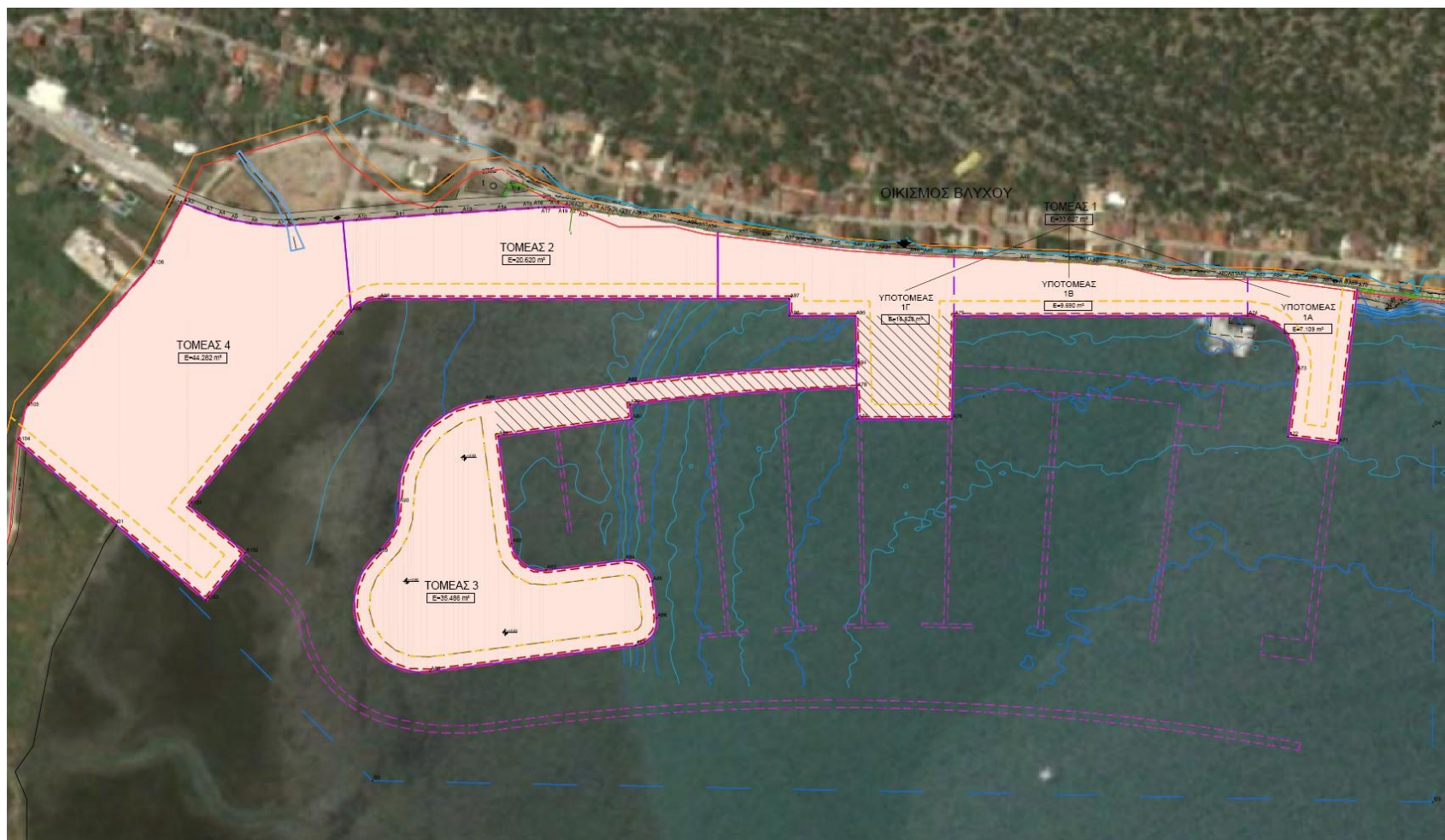
Σχήμα Δ 2: Χωροταξική οργάνωση χερσαίας μαρίνας ανά τομείς (Υπόβαθρο: Δορυφορική εικόνα Google Earth και ίδια επεξεργασία)
